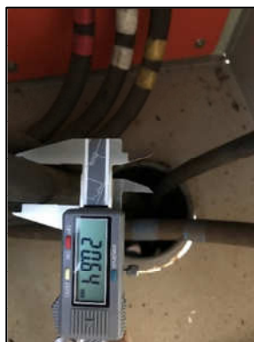
Fig. 6 – Diâmetro externo dos cabos de fase
