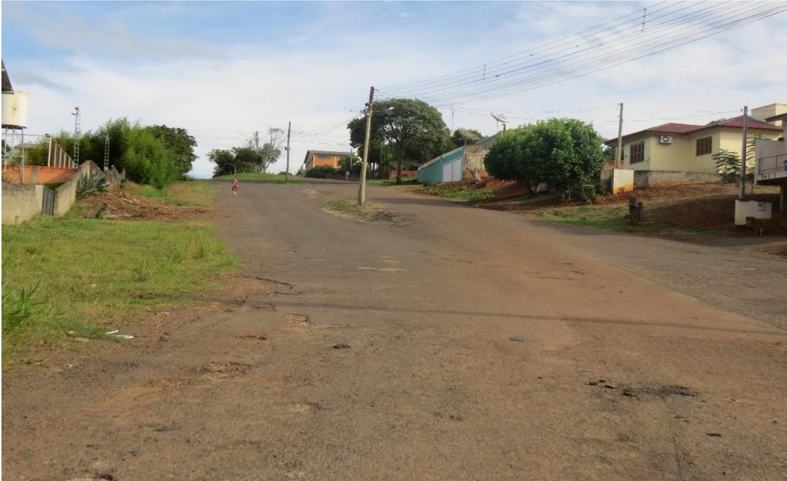
Foto 02: Avenida Brasília. Microdrenagem existente de um lado da rua. Será executada a microdrenagem do outro lado da rua até o Arroio Aquático. As bocas de lobo existentes serão limpas e adequadas até a altura do pavimento a ser executado. A rede elétrica passa no meio da rua onde será feito o canteiro central.
