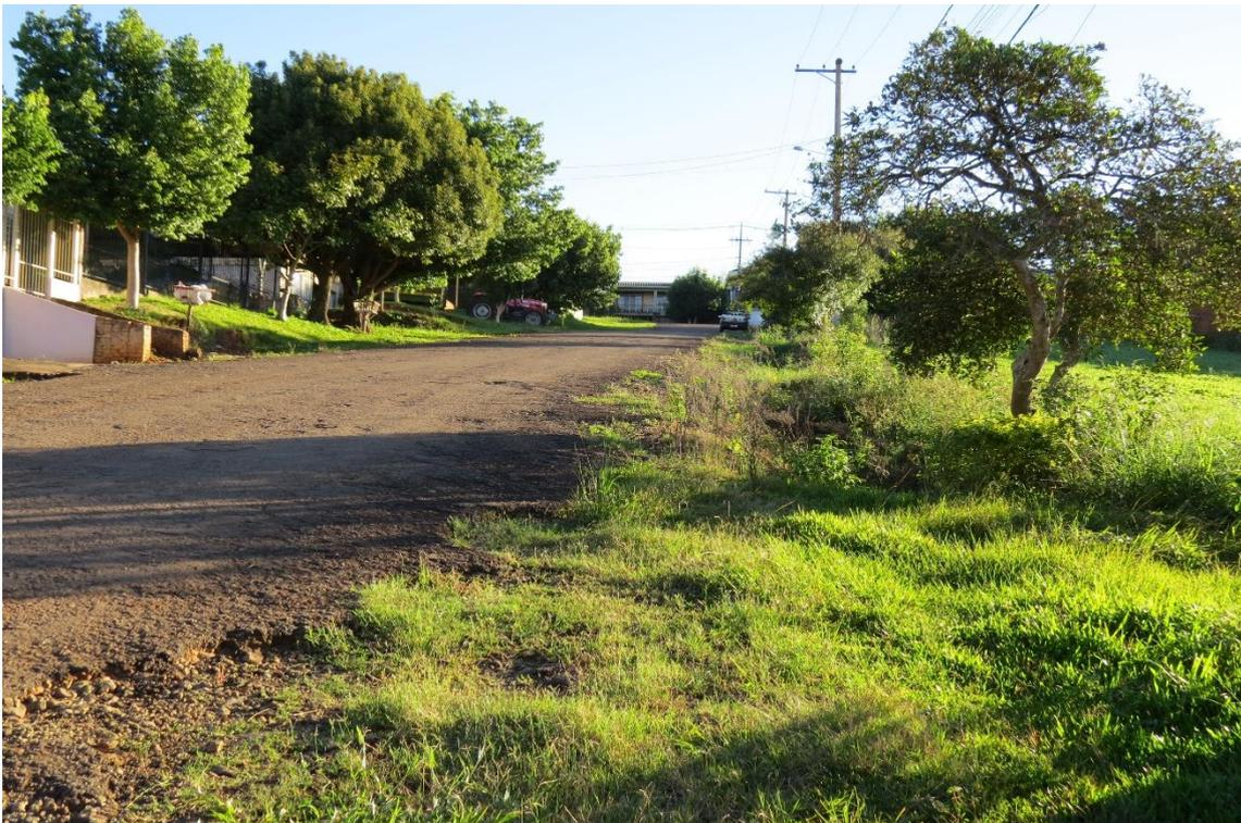
Foto 13: Rua Centenário. Existem trechos com microdrenagem, outras partes se formaram valetas. Será executada microdrenagem e feita adequação das bocas de lobo existentes.
