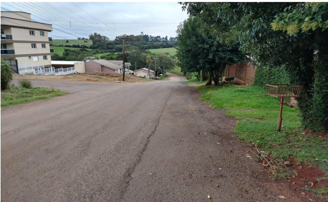
Foto 07: Rua Amazonas. Existe revestimento de resíduo asfáltico. Microdrenagem existente, serão limpas e adequadas as bocas de lobo existentes até a cota da pavimentação a ser executada.
