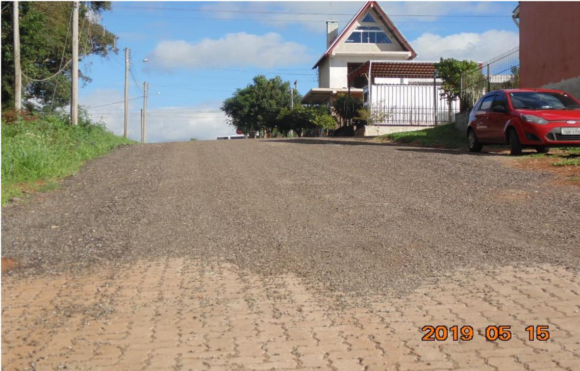
Foto 14: Rua Jan Rauwers. Será executada pavimentação em CBUQ com espessura de 04 cm e base de 15 cm. Meio fio em concreto pré-moldado. Existe revestimento de resíduo asfáltico. Microdrenagem existente serão limpas e adequadas às bocas de lobo.
